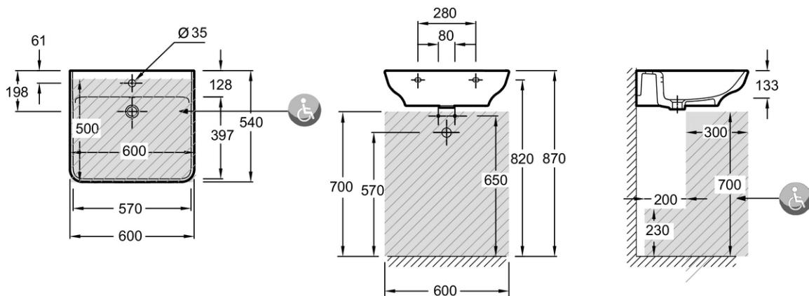
Descriptif CCTP : Lavabo PMR 60 cm, non meulé. EGG111. Collection : STRUKTURA. DIMENSIONS : 60 x 54 cm. POIDS : 19,6 kg. MATÉRIAU : Céramique. TYPE D'INSTALLATION : Autoportant. NORMES ET RÉGLEMENTATIONS : NF. CONFIGURATION : Standard. PERCEMENT ROBINETTERIE : 1 trou. MEULÉ/NON-MEULÉ : Non meulé. TROP-PLEIN : Avec trou de trop-plein. NOMBRE DE VASQUES : 1 cuve. DURÉE GARANTIE (ANNÉES) : 10. INFORMATIONS COMPLÉMENTAIRES : Bonde et robinetterie non incluses.
